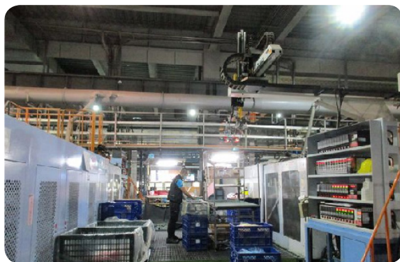
機械手自動取出成形零件
